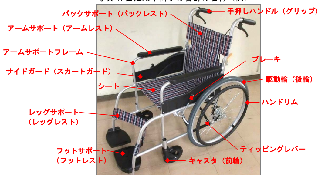
写真1. 自走用車椅子の各部の名称(例)
